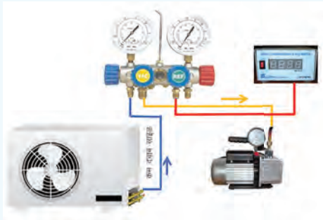
चित्र 7.10: सिस्टम को खाली करने (इवैक्युएशन) की प्रक्रिया का पहला कदम
